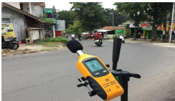
**Gambar 3.** Alat Tingkat Kebisingan *Sound Level Meter* type HT - 80A
