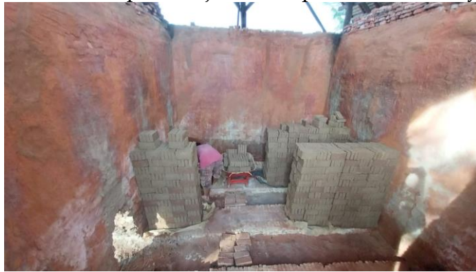
Gambar 4.2 susunan batu bata ke dapur pembakaran
